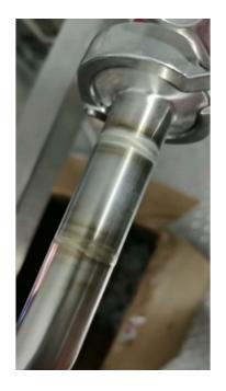
洁净管道的应用:在制药、食品、生物医疗行业中有大量的工艺过程涉及到分配系统。如:纯化水的分配系统,注射用水的分配系统,药液在配制容器之间的传输和分配等等。这些分配系统所采用的洁净管道在焊接上除了要达到常规工业管道对焊缝的要求外,还要求焊接时管内、外表面不受污染,焊缝内、外表面必须与母材光亮度基本一致,并能够满足制药学、卫生学的要求。因此对是施工队伍,及焊接工具具有较高要求,一般需要自动焊机对洁净管路进行焊接,减少人为误差。
